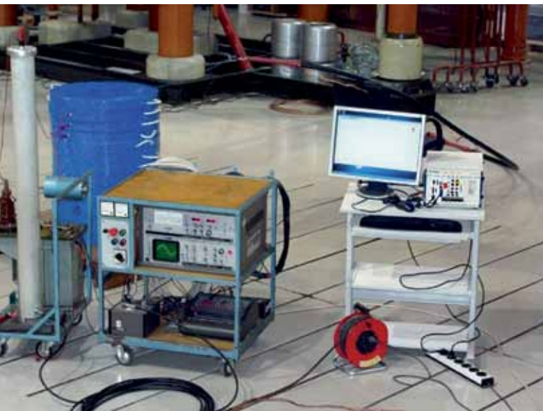
Slika 5: Resonančni napajalno merilni sistem 40 kV, 50 Hz
