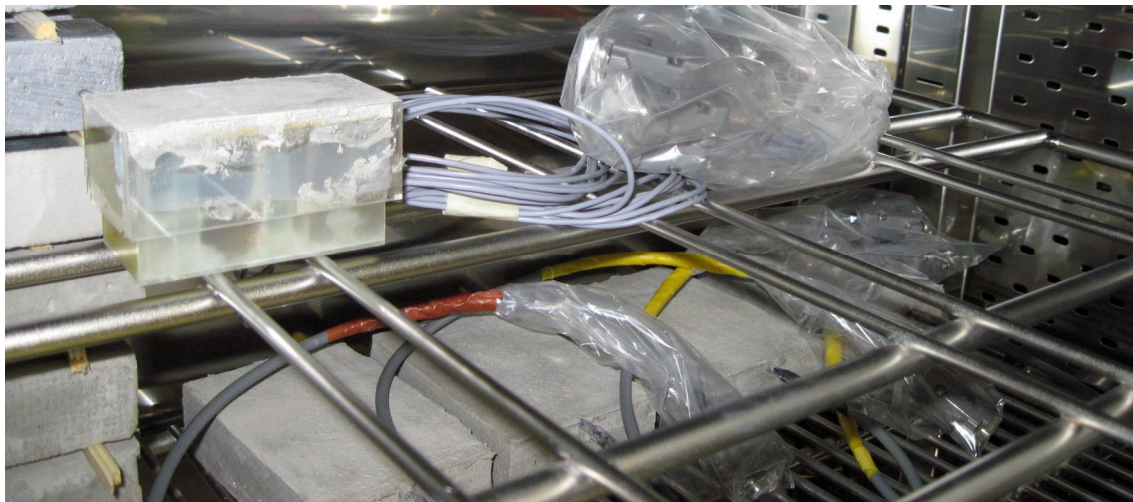
Slika 33: Vzorci v komori za pospešeno karbonatizacijo
