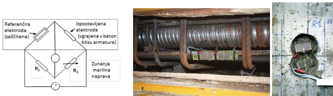
Slika 11: a) Shema Wheatsonovega mostička v elektro-uporovnem senzorju; b,c) vgradnja senzorja na konstrukciji
