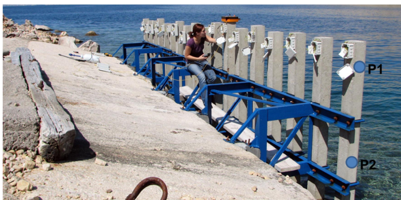
Slika 18: Meritve na stebrih na Krku. Na desni strani slike sta z oznakami »P1« ter »P2« označeni mesti merjenja korozijskih hitrosti z galvanostatskim pulzom.
