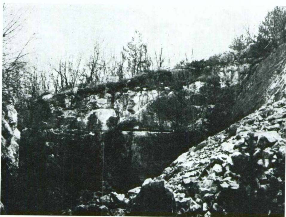
Sl. 5. Vzhodna stena kamnoloma Lisično I. Vidna je vrzel po plastovitosti, imenovana »daska«
