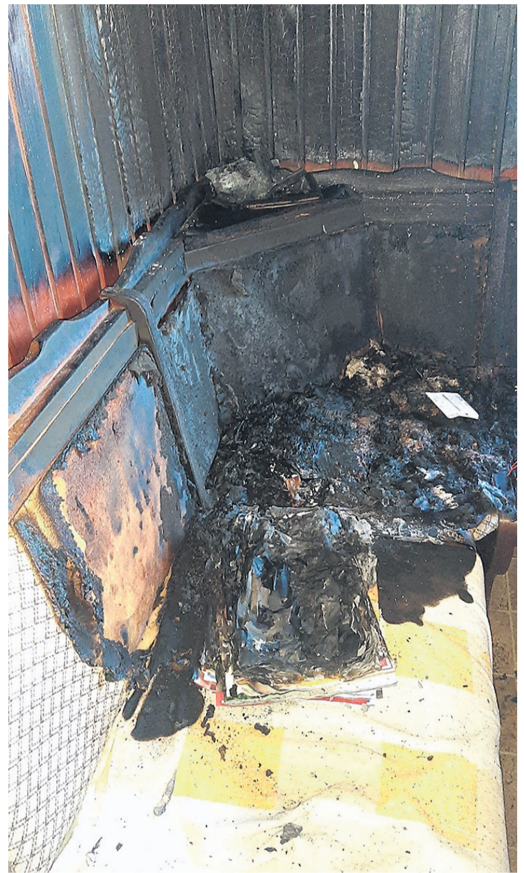
Oblazinjena klop, kamor je po eksploziji padla baterija in zanetila požar
