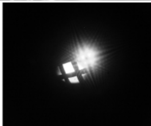
Slika 4: Nekateri nanostrukturirani materiali so pogosto že ob sintezi urejeni v obliki nanocevok in nanožic, ki se končajo kot atomsko ostre konice. Le-te omogočajo hladno emisijo elektronov v zmerno močnem električnem polju, kar lahko uporabimo v vrsti elektronsko optičnih naprav. Na zgornji sliki je vakuumska diodna celica za meritev in opazovanje kotne porazdelitve emitiranega toka (naredili so jo v Odseku za tehnologijo površin in optoelektroniko na Insitutu "Jožef Stefan" v sodelovanju s podjetjem LPKF), ki izhaja iz anorganskih nanocevok, sintetiziranih na IJS. Na spodnji sliki je vzorec elektronov, ki izhaja iz osamljene nanocevke. Med njo in zaslonom je nameščena fina kovinska mrežica. Strukturo dodatne slike povzročijo sipani in odbiti sekundarni elektroni, ki izhajajo iz mrežice.
