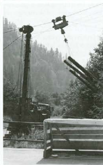
Gozdarska žičnica Mobil 2500 Razvojni projekt: • Tehniška fakulteta Maribor • Vojaški inštitut JNA Beograd • Strokovnjaki Gozdnega gospodarstva. Izdelan leta 1990.
