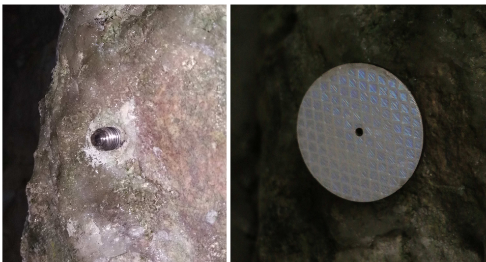
Slika 7 - Točka geodetske mreže oz. oslonilna točka za TLS: levo sidrni vijak, desno okrogla reflektivna tarča s premerom 5 cm
