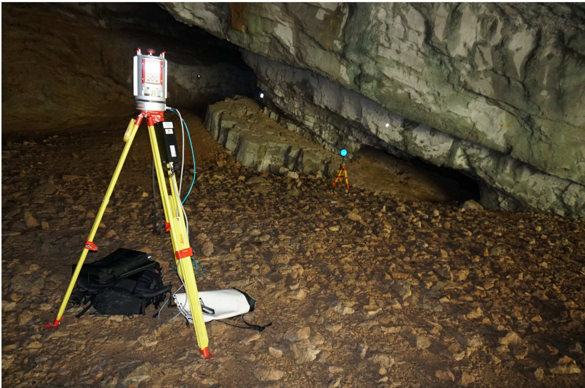
Slika 8 - Skener Riegl VZ-400 ter oslonilne in vezne točke (reflektivne nalepke, valjčki, tarča Leica 6")
