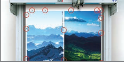
Koncept nadzora rezanja z OCC-kamero.
