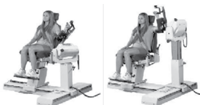
Slika 1: Običajni meritveni položaji za testiranje moči zunanjih in notranjih rotatorjev ramenskega sklepa (levo: roka v addukciji, desno: roka v abdukciji v tako imenovanem funkcionalnem položaju)
