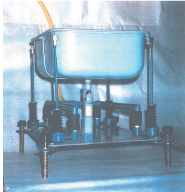
Skica in prototip naprave za izrabo energije morskega valovanja. Celotna naprava naj bi stala v vodi, razen dveh tretjin plavajoče ponve. Ta se giblje v vse štiri smeri in tudi vertikalno, s čimer se prilagaja plimi in oseki. Ponev služi za poganjanje tlačilk, ki vodo po cevovodu potiskajo v akumulacijski bazen na obali. Ko se voda vrača v morje in pri tem teče skozi turbinski sistem, se ustvarja električna energija.
