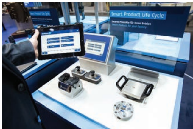
» Pametni vpenjalni sistemi proizvajalca Schunk posredujejo podatke o vpetju v obdelovalni stroj ter v baze podatkov. | Vir: Schunk
