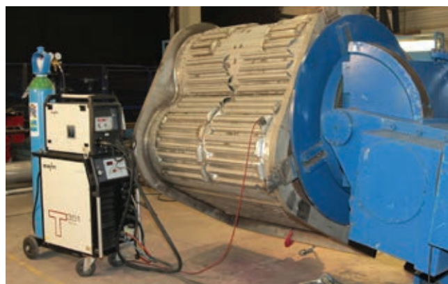
» Slika 7: Kombinacija TIG vroče žice in tigSpeed zmanjša čas varjenja za AST za 40 odstotkov.
