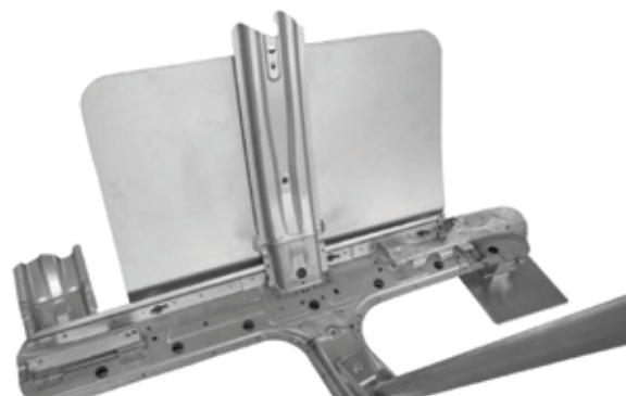
» Slika 2: Dodatni, dragi procesi povezovanja, kot je npr. kovičenje, postanejo preteklost z uporabo varjenja CMT – kar vodi do večje stroškovne učinkovitosti.
