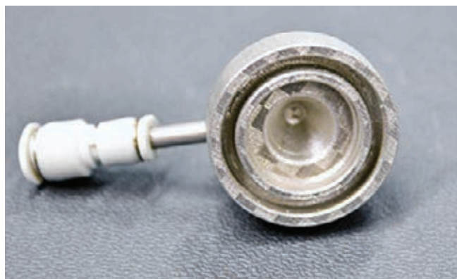
» Kovinsko aditivno izdelano oljno vodilo (Courtesy GE Additive)
