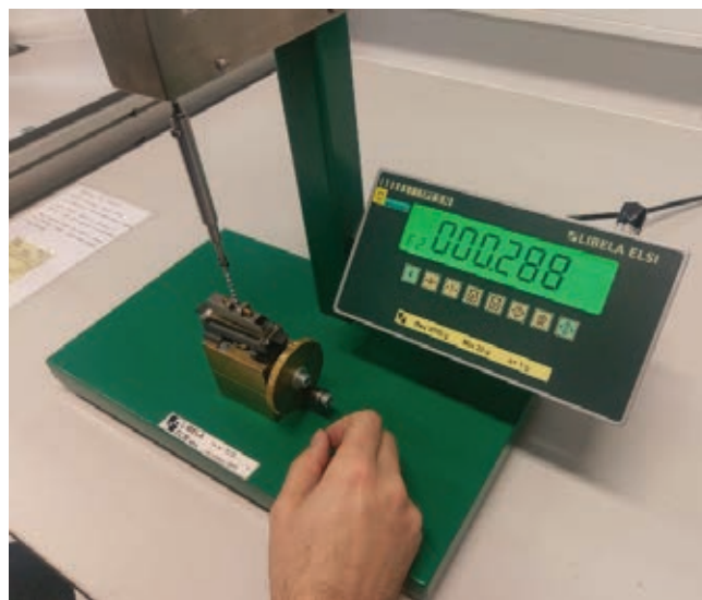
» Slika 6: Merilni sistem za merjenje sile magneta na enoto dolžine
