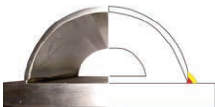
» Slika 6: Varjeno na polovični cevi. Notranjost polcevi je prirezana. Koren TIG-zvarnega šiva (rdeča) potisne navznoter. Z drugim, MAG šivom (rumenim) dosežemo potrebno debelino grla.
