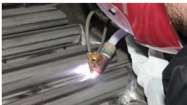
» Slika 3: Glava gorilnika z mehaniziranim dovajanjem polnilne žice povečuje stopnjo usedanja za do 60 odstotkov.
