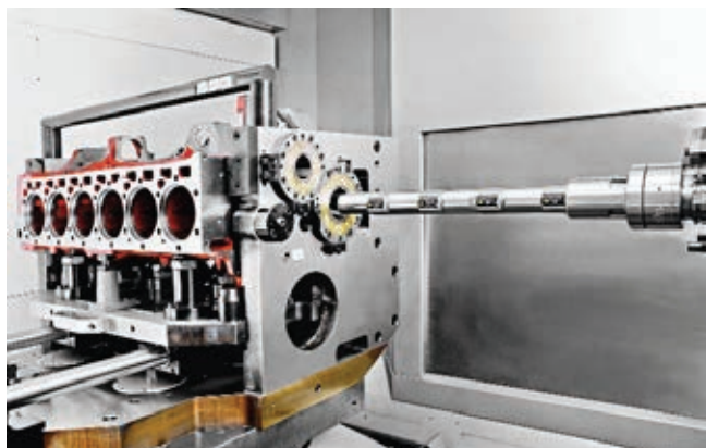
» Celotna obdelava V12 bloka motorja za Caterpillar: izdelava cilindrov na obdelovalnem centru Starrag. | Vir: Starrag
