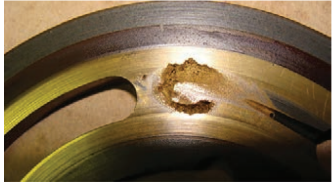
» Slika 3) Posledica kavitacije – poškodovana ventilska plošča aksialne batne črpalke
