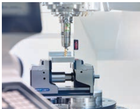
» Inteligentno držalo orodij iTENDO omogoča spremljanje in nadzor procesov v realnem času neposredno na orodju. Geometrija in podatki o zmogljivosti držal orodij ostajajo nespremenjeni tudi pri sistemih s senzorji.
