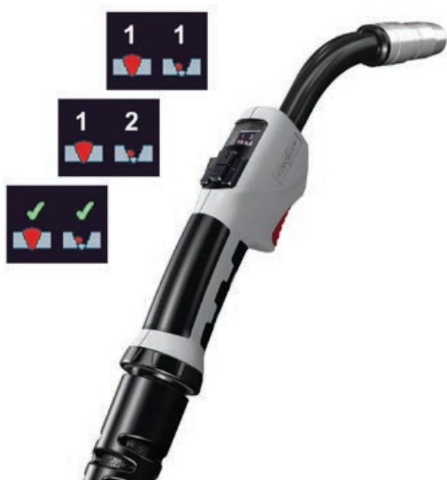
» Slika 4: Novi sistem upravljanja komponent ewm Xnet bistveno izboljša učinkovitost. Za nadaljevanje dela morajo varilci potrditi vsako opravljeno nalogo na samem obdelovancu s pomočjo gorilnika PM.
