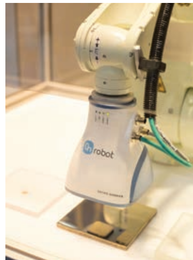
» Adhezivno robotsko prijemalo Gecko danskega proizvajalca OnRobot, ki deluje brez uporabe lepil ali vakuuma. (Vir: MachineDesign)
