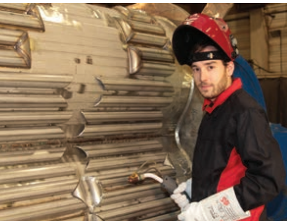
» Slika 4: Poleg standardnih TIG-gorilnikov s hladno/vročo žico, EWM ponuja tudi različico TIG z gorilnikom, integriranim v ročaj MAG. AST je izbral to različico s poenostavljenim rokovaljem.
