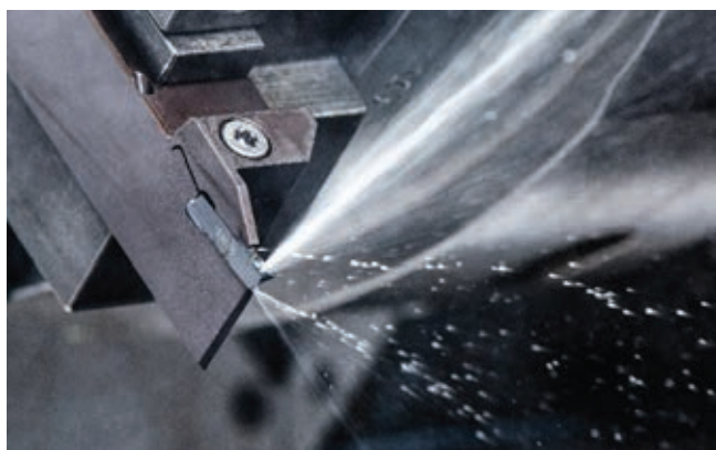
» Neposredno hlajenje v območje odrezovanja: Rezalni insert z dvema rezalnima robovoma Paul Horn S224 s hlajenjem napeljanim skozi sam insert. | Vir: Paul Horn
