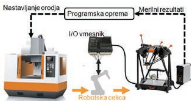
» Slika 2: Prikaz zaprtizančne, popolnoma avtomatizirane proizvodne celice
