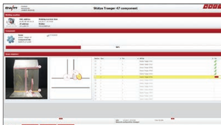
» Slika 6: Upravljanje komponent, načrtovanje zaporedja varjenja in dodelitev WPS – nov sistem za upravljanje komponent ewm Xnet prikaže vse ključne informacije.
