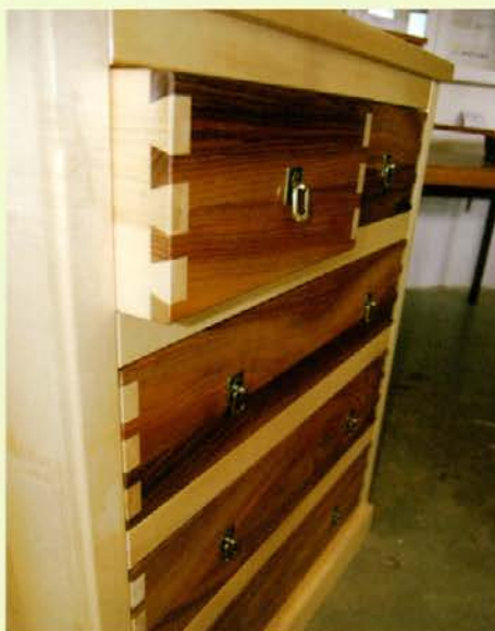
Predalnik iz masivnega lesa z rogeljno vezjo, ki ga je izdelal dijak Rok Kos
