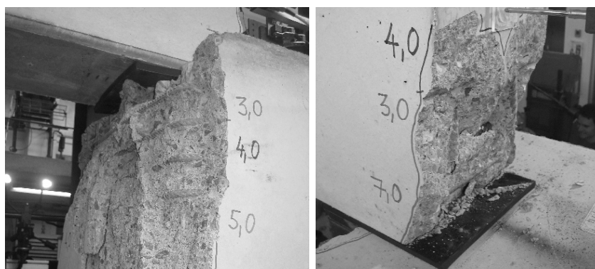
Slika 2.12: Preizkušavec S6: močne poškodbe stebra in grede.
