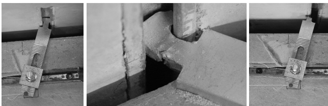
Slika 3.10: Stiki TA-AS s kanali HTA 40/22: zagozdenje glave jeklene ploščice v kanalu v panelu (levo), velike plastične deformacije pod glavo ploščice (v sredini) ter porušitev ploščice zaradi kombinacije upogibnih in nateznih obremenitev (desno).
