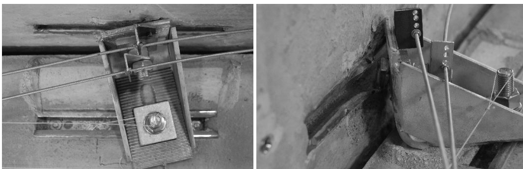
Slika 3.19: Odziv stikov PARD2: kotnik rotira okrog vijaka v nosilcu, pri tem pa se naslanja na panel, kar povzroči natezne sile v vijaku v panelu (levo); končno se stik poruši zaradi izpuljenja vijaka iz kanala (desno).
