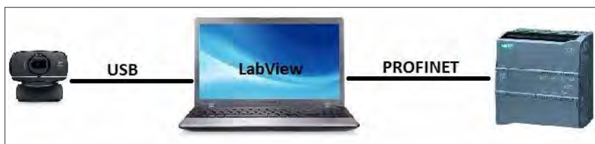
Slika 9. Povezava: spletna kamera-računalnik-PLK
