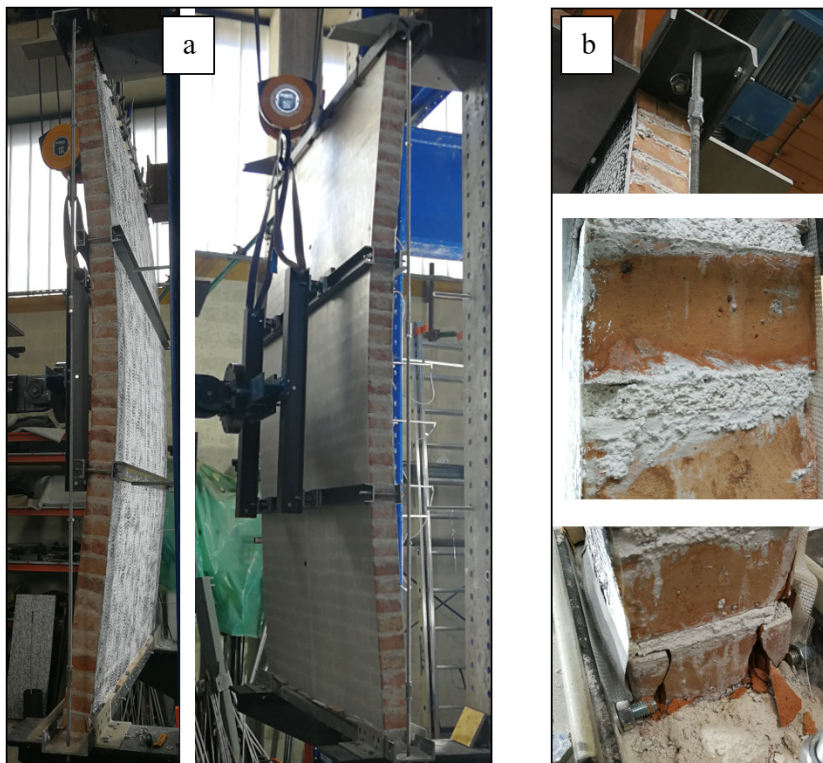
Slika 5.43: Preizkušanje nekonstrukcijskega zidu NF-3A: (a) Značilna deformacijska oblika, (b) poškodbe preizkušanca med cikličnim obremenjevanjem.
