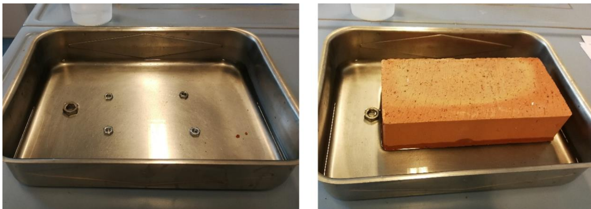
Slika 4.3: Posoda za določitev začetne vodovpojnosti s podložnimi maticami (levo) in določanje začetne vodovpojnosti NF opeke (desno).
