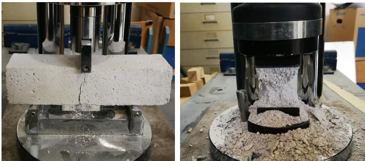
Slika 4.12: Preizkus upogibne natezne trdnosti prizem (40/40/160 mm) podaljšane apneno cementne malte (levo) in tlačne trdnosti (desno).
