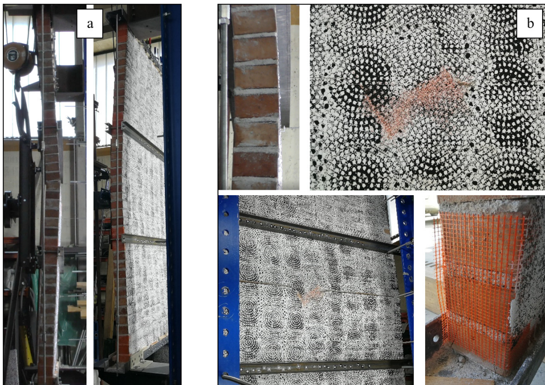
Slika 5.99: Preizkušanje nekonstrukcijskega zidu NF-1E: (a) Značilna deformacijska oblika, (b) poškodbe preizkušanca med kvazi-statičnim cikličnim obremenjevanjem.
