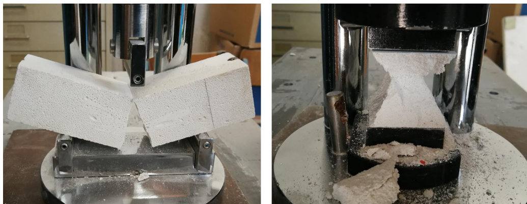
Slika 4.17: Preizkus upogibne natezne trdnosti prizem (40/40/160 mm) tankoslojne lepilne malte (levo) in tlačne trdnosti (desno).
