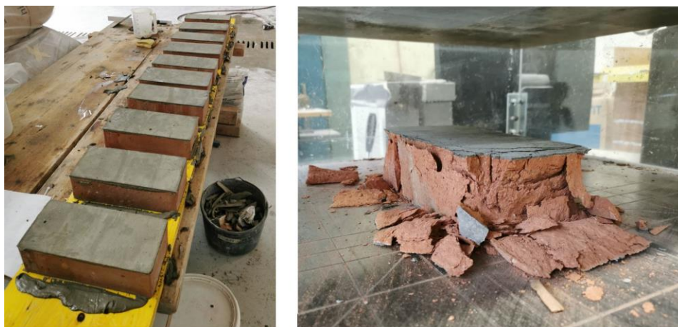
Slika 4.5: Izravnava naležnih površin vzorcev zidakov normalnega formata (levo) in primer tlačne porušitve zidaka normalnega formata po končani standardni tlačni preiskavi (desno).
