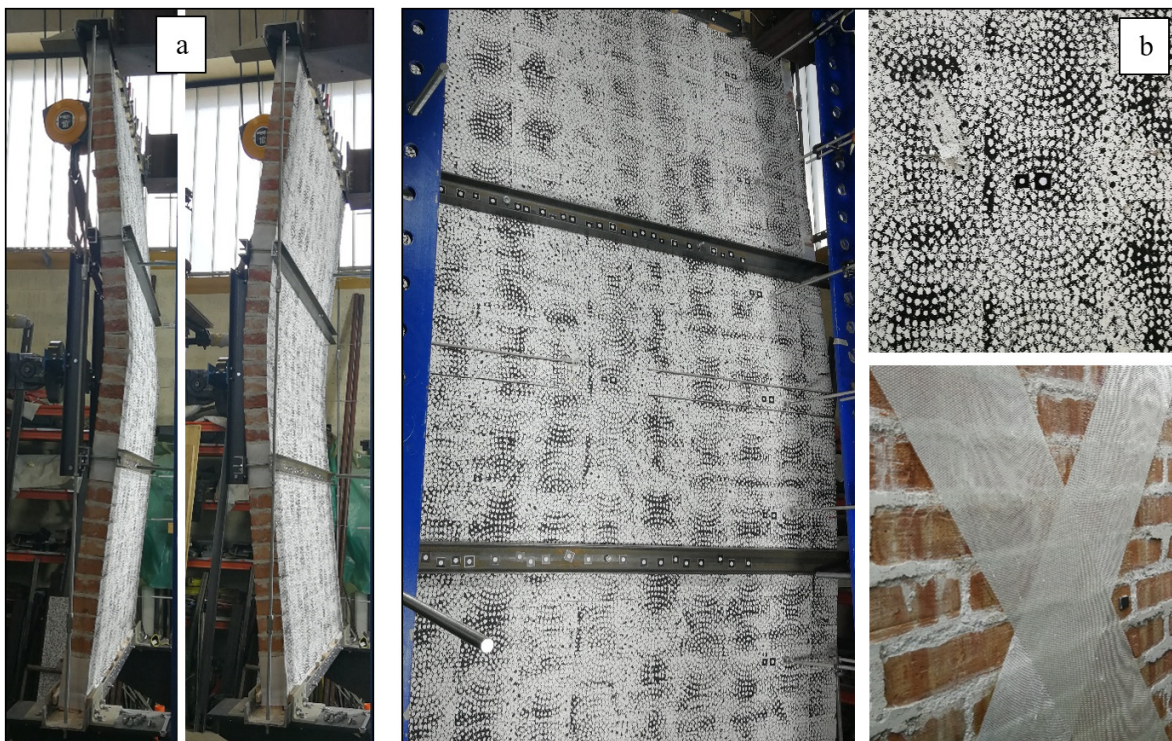
Slika 5.89: Preizkušanje nekonstrukcijskega zidu NF-1D: (a) Značilna deformacijska oblika, (b) poškodbe preizkušanca med kvazi-statičnim cikličnim obremenjevanjem.
