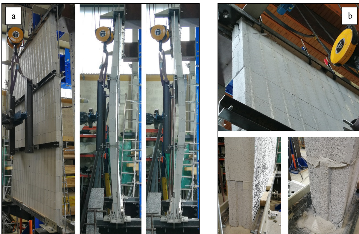
Slika 5.84: Preizkušanje nekonstrukcijskega zidu YT-1C: (a) Značilna deformacijska oblika, (b) poškodbe preizkušanca med kvazi-statičnim cikličnim obremenjevanjem.
