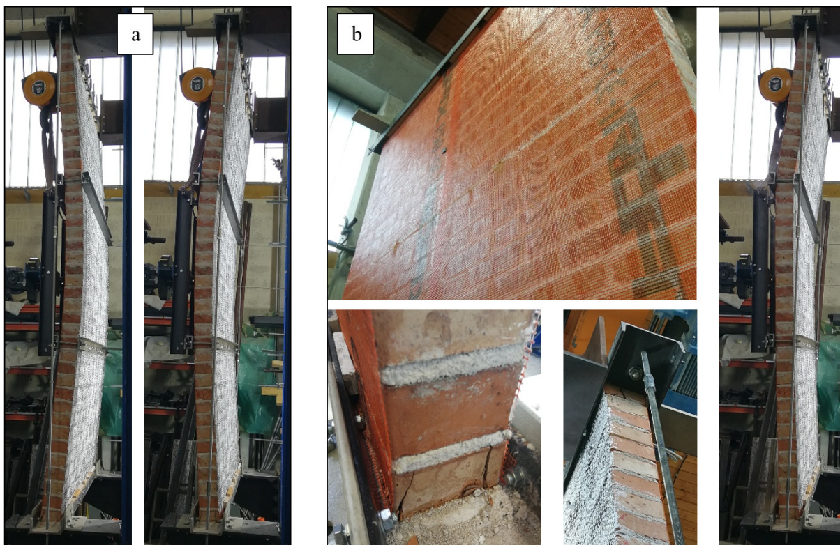
Slika 5.63: Preizkušanje nekonstrukcijskega zidu NF-3B: (a) Značilna deformacijska oblika, (b) poškodbe preizkušanca med kvazi-statičnim cikličnim obremenjevanjem.
