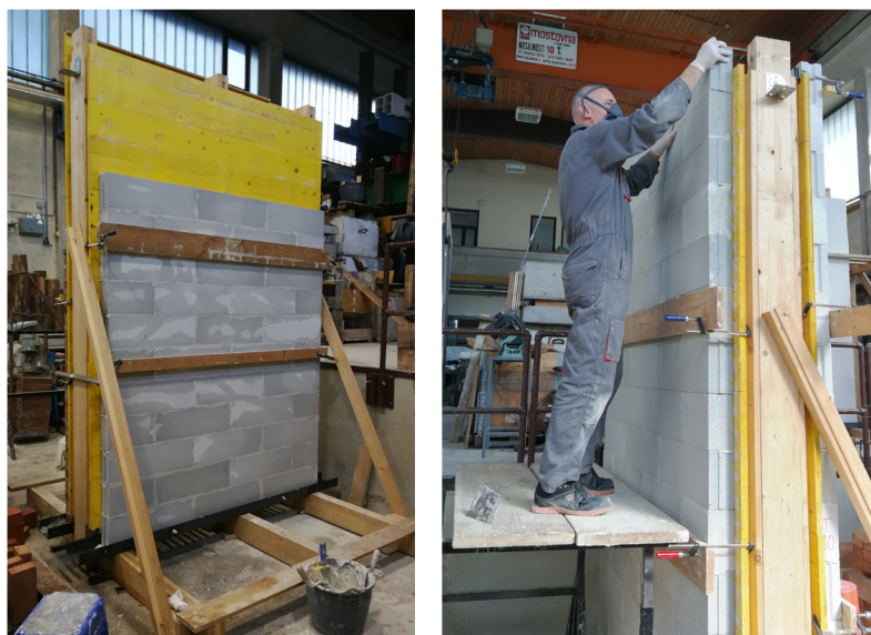
Slika 5.4: Izgradnja YT preizkušanca. Figure 5.4: Building a YT specimen.
