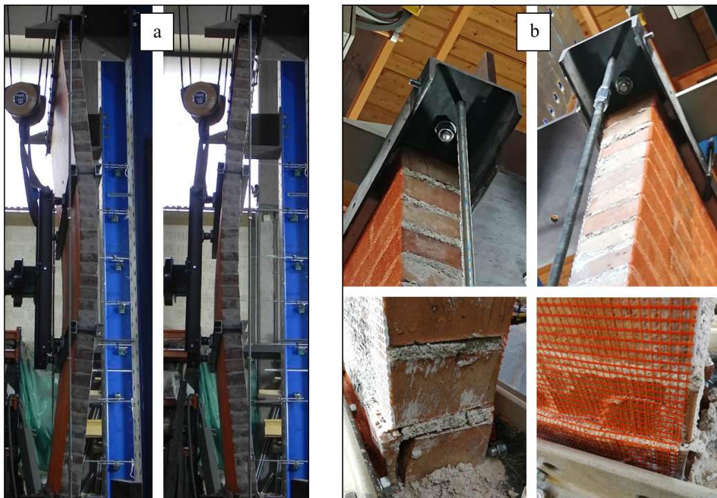
Slika 5.59: Preizkušanje nekonstrukcijskega zidu NF-1B: (a) Značilna deformacijska oblika, (b) poškodbe preizkušanca med cikličnim obremenjevanjem.
