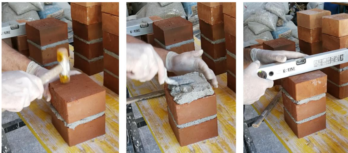
Slika 4.21: Izdelava zidanih prizem iz polovičk zidakov normalnega formata. Figure 4.21: Preparation of prism specimens made of brick halves.
