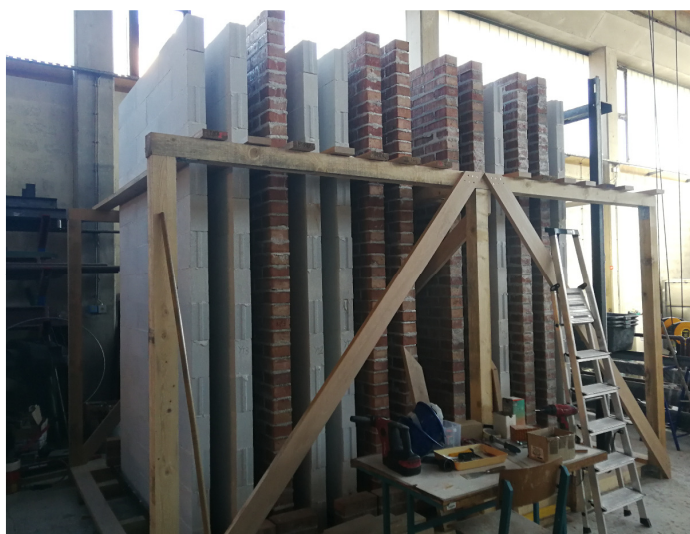
Slika 5.5: Staranje glavni preizkušancev nekonstrukcijskih zidov. Figure 5.5: Aging of main specimens of non-structural walls.
