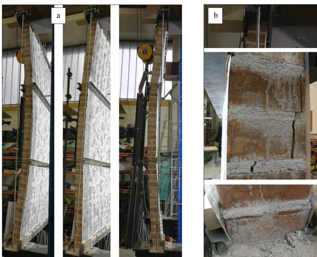
Slika 5.39: Preizkušanje nekonstrukcijskega zidu NF-1A: (a) Značilna deformacijska oblika, (b) poškodbe preizkušanca med cikličnim obremenjevanjem.
