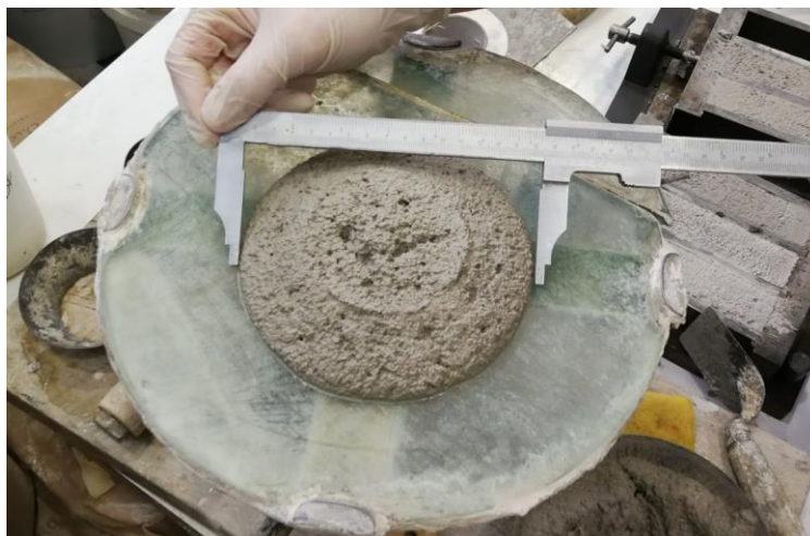
Slika 4.13: Določitev konsistence sveže malte s stresalno mizo.
