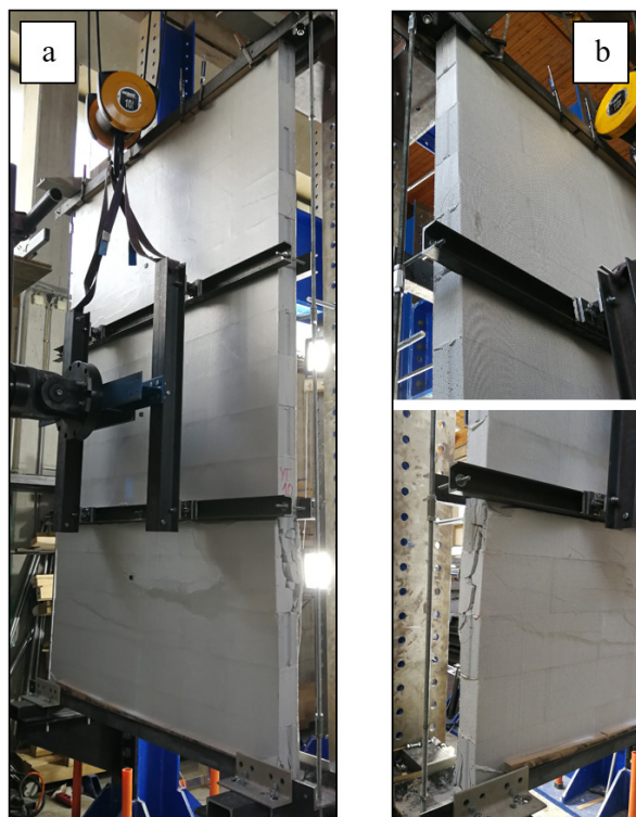
Slika 5.53: Preizkušanje nekonstrukcijskega zidu YT-3A: (a) Značilna deformacijska oblika, (b) poškodbe preizkušanca med cikličnim obremenjevanjem.
