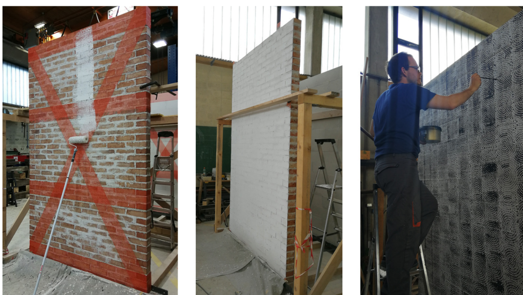
Slika 5.15: Priprava vzorca za digitalno optično metodo zajema pomikov in deformacij. Figure 5.15: Specimen's front surface preparation for the optical digital image correlation method.
