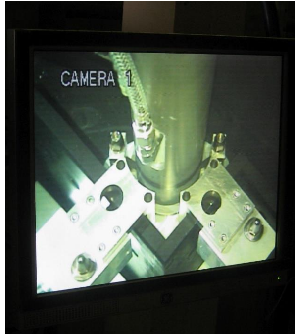
Slika 74: Orodje (levo) in EDM izdelava izvrtin za modifikacijo UFC (Foto: inšpekcija URSJV)
