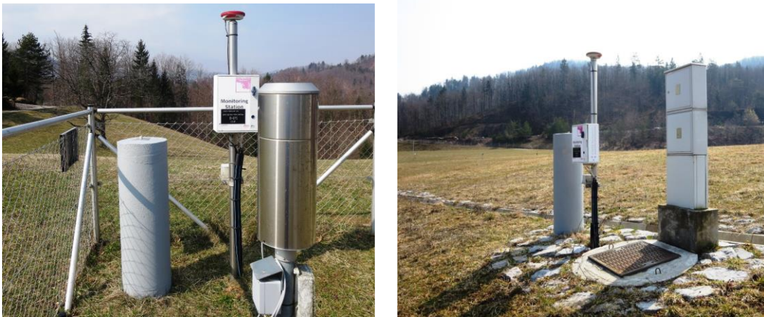
Slika 78: Opazovalna točka GPS nadzora stabilnosti območja odlagališča Boršt GMX1 na lokaciji vremenske postaje Boršt – Gorenja vas – levo in Opazovalna točka GPS nadzora stabilnosti območja odlagališča Boršt GMX2 na zgornji etaži odlagališča - desno
