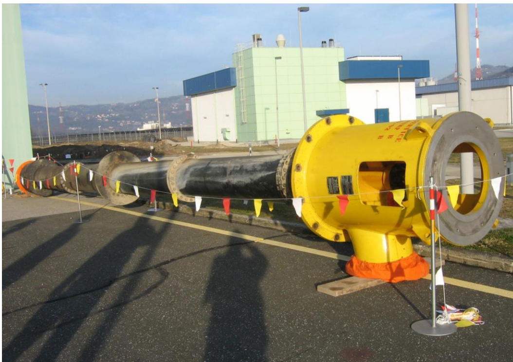
Slika 71: Rotor SW črpalke B (Foto: inšpekcija URSJV)
