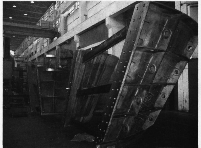
Predvodilnik za prvi agregat boštanjске HE je trenutno na obdelavi, 8. decembra pa bo že na gradbišču v Boštanju.
