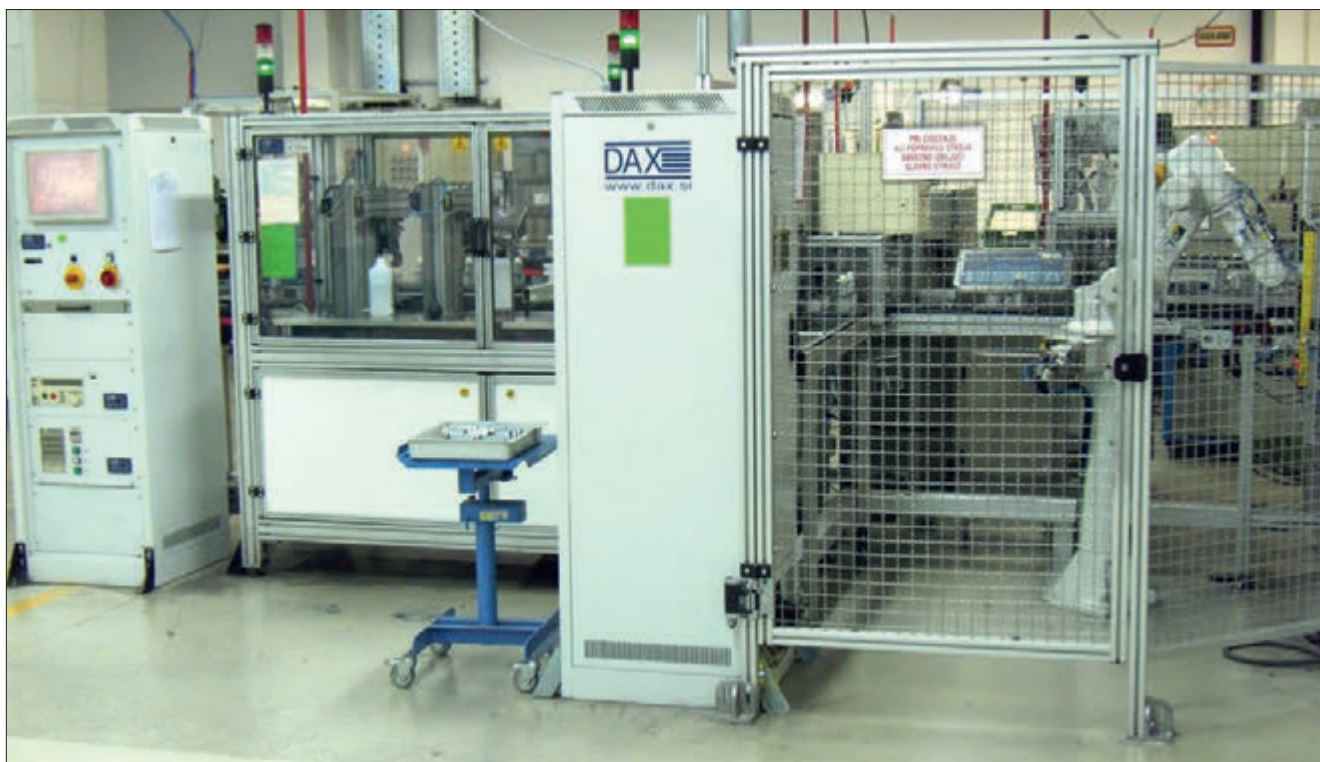
Slika 1. Ena od linij za sestavo in meritve DC motorjev pred nadgradnjo
