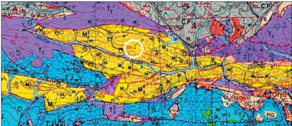
Slika 8. Izsek iz Osnovne geološke karte SFRJ. Z rumeno so označene različne miocenske plasti. Okolica Lipovice je označena z belim krogom. Po Osnovni geološki karti, lista Ljubljana, merilo 1:100.000, po PREMUR, 1983a.
