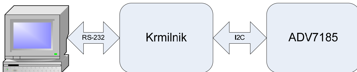
Slika 8: Nastavljanje parametrov vezja ADV7185 s PC-jem prek krmilnika
