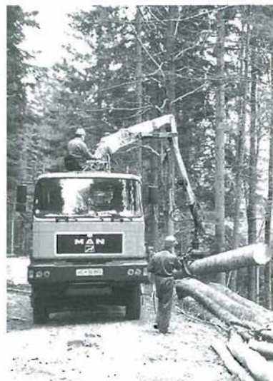
Sodoben kamion MAN GG Postojna, opremljen s hidravlično nakladalno napravo LIV Postojna.
