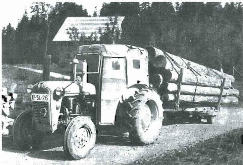
Slika 2: Prevoz lesa s prvo traktorsko gozdarsko prikolico GPP-1 (Foto: Arhiv GGP)
