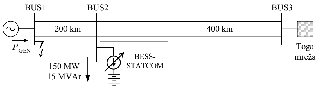
Slika 3.7: Longitudinalni testni sistem z napravo BESS-STATCOM
