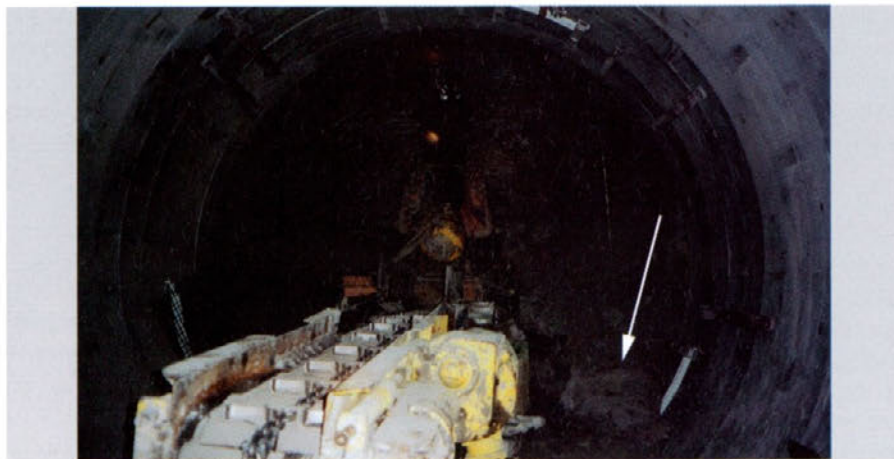
Mesto nezgode na pripravski številki 22; desno spodaj ob napredovalnem stroju kos odtrgane hribine
