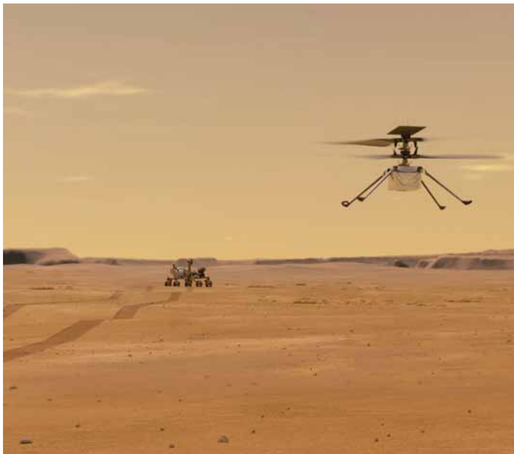
Helikopter Iznajdljivost, ki bo prvi poskusil opraviti propellerski let na drugem planetu. Leteti na Marsu je izjemno težko, saj je njegovo ozračje kar stokrat redkejše kot Zemljino. Zato je helikopter Iznajdljivost zelo lahek in ima propelerje, ki se vrtijo z več kot 2.000 obrati na minuto. Foto: NASA/JPL-Caltech.
