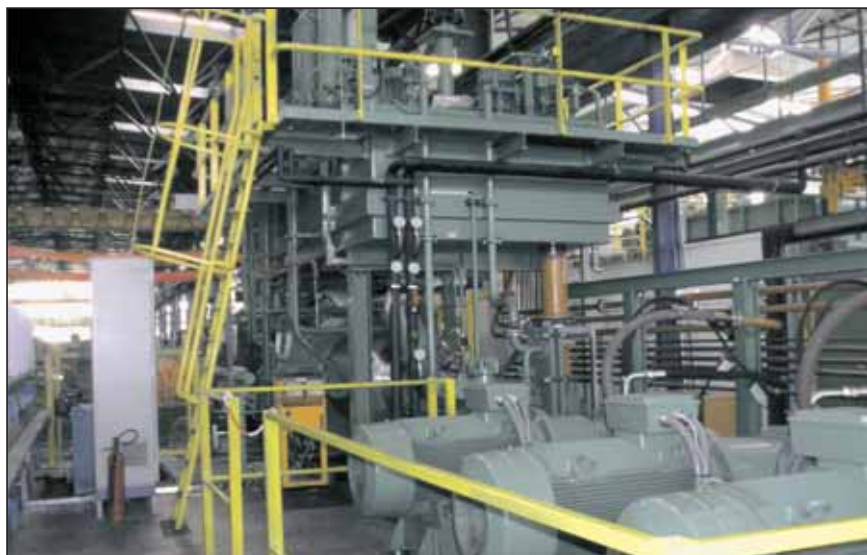
Ena od šestih stiskalnic, 20 MN-stiskalnica v podjetju s proizvodno linijo
