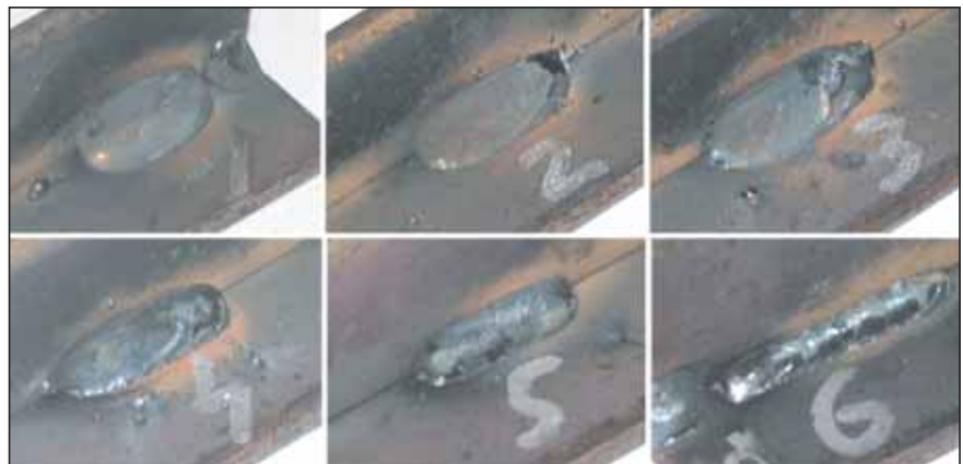
Slika 5. Fotografije talilnih zvarov, izdelanih v različnih režimih
