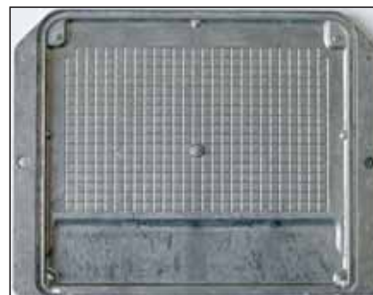
Slika 14. Fotografija merjenca: predmet nadzora je ravna ploskev po svetlečim pasom
