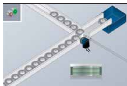
Slika 13. Preverjanje tipa krogličnega ležaja
