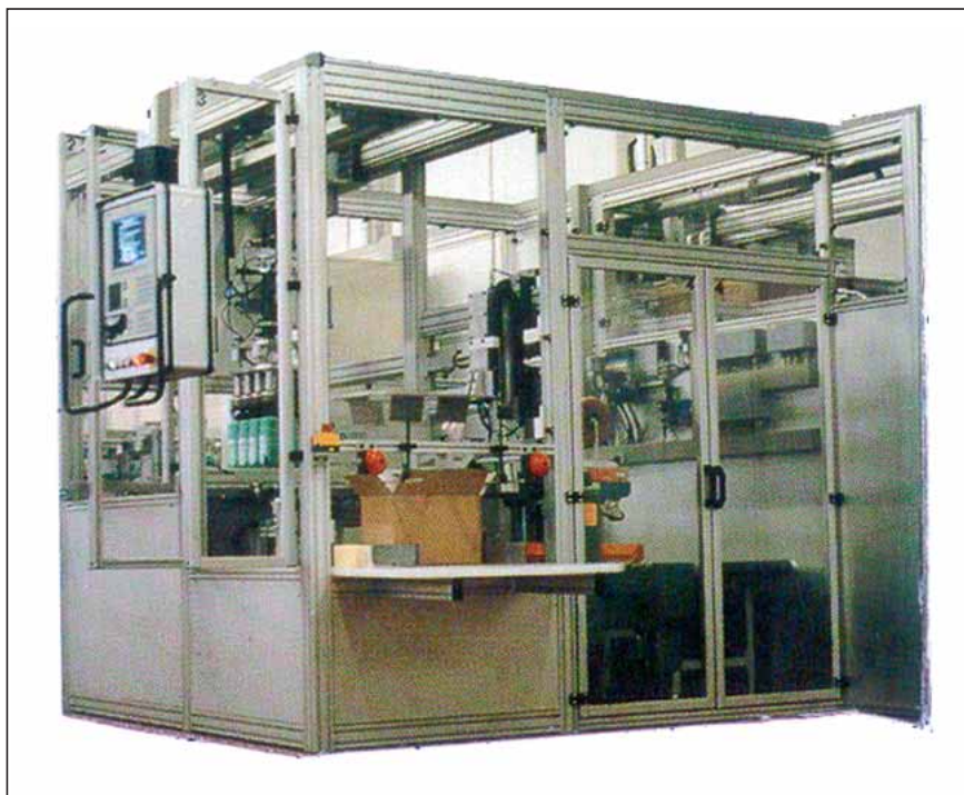
Slika 5. Stroj za polnjenje zabojev in kartonov s platenkami
