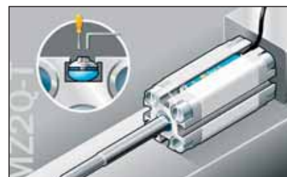
Slika 1. Pritrditev senzorja MZ2Q-T
