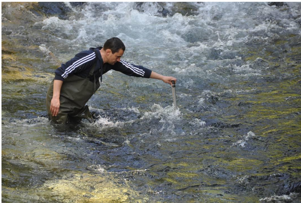
Slika 12: Prikaz meritev globin vode z vodomerno lato (08.06. 2012).
