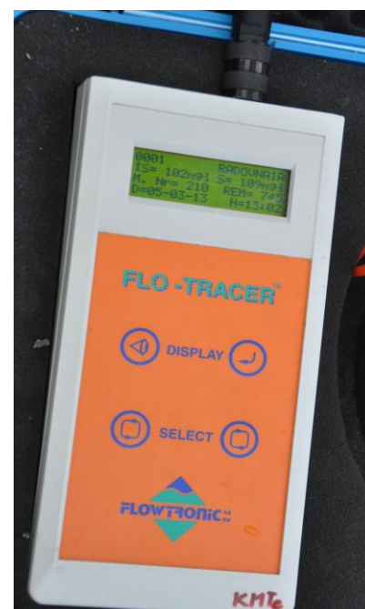
Slika 11: Prikaz meritev pretoka s prenosnim merilcem Flo-Tracer.
