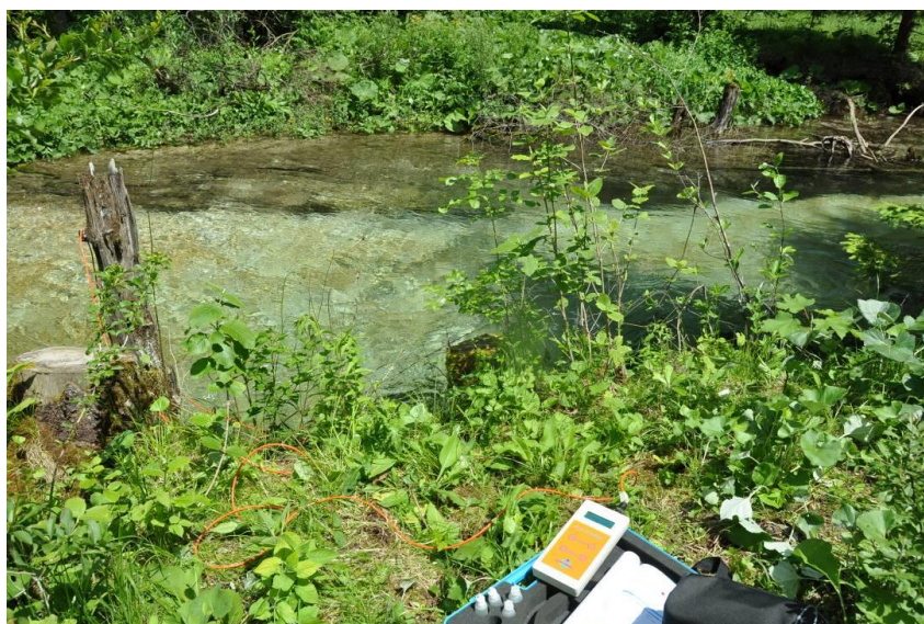
Slika 11: Prikaz meritev pretoka s prenosnim merilcem Flo-Tracer.
