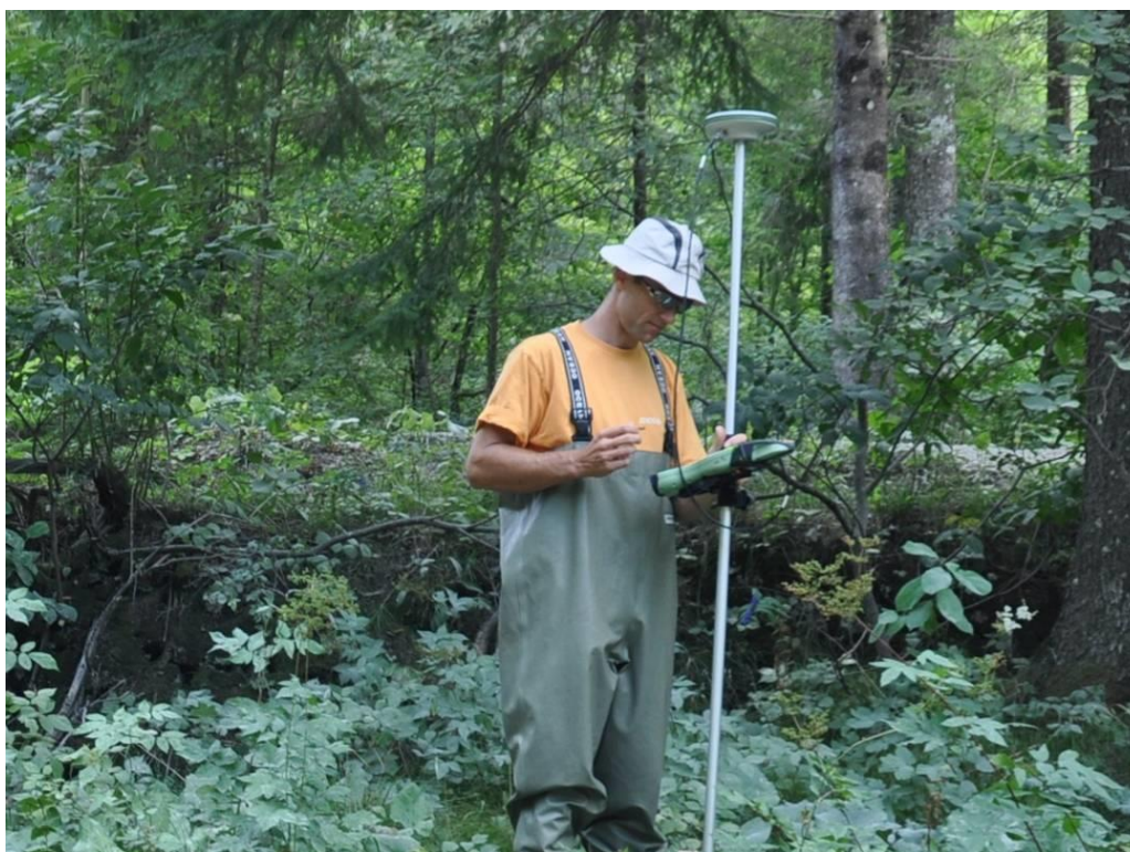
Slika 13: Meritve z Leico – meritve geodetskih točk in globin vode.
