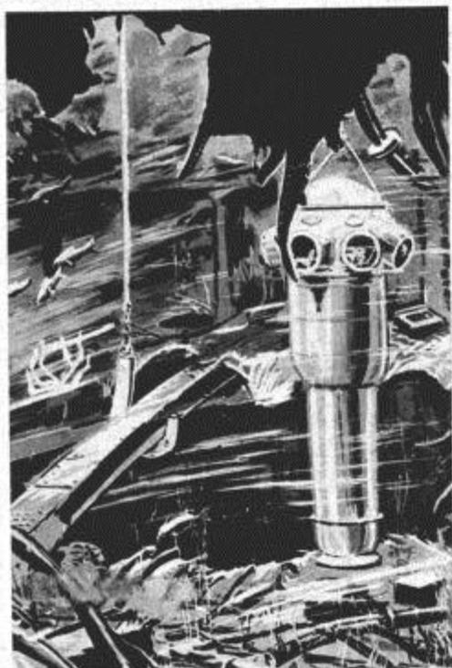
In einem Panzerturm, Einmann-U-Boot genannt, wird der Leiter der Bergungsarbeiten herabgelassen. Ein Streif von Beobachtungsfenstern ermöglicht ihm den Rundblick, ferner besteht telephonische Verbindung mit den arbeitenden Tauchern. Scheinwerfer beleuchten die Arbeitsstätte
