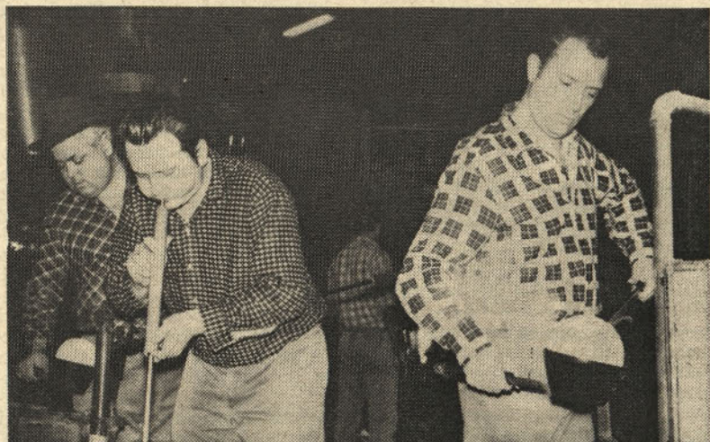
Brigada tov. Percl Adija pri izdelavi ročno pihanih razsvetljavnih teles
