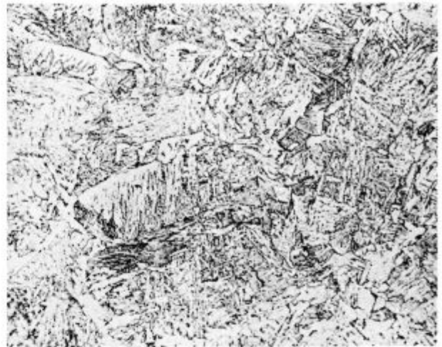
Slika 13 Bainitno feritna struktura prehodne zone; 200 × povečava
