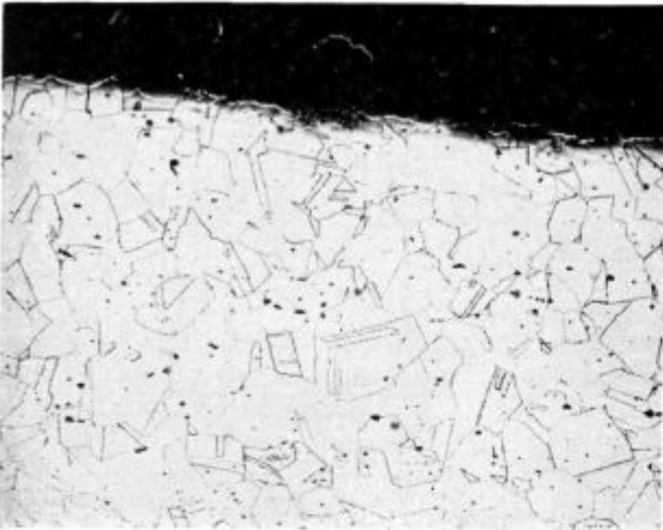
Slika 8 100 × — Struktura gašenega preizkušanca
