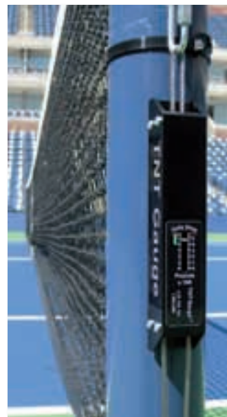
△ Net Cord Sensor je piezoelektrični element, ki zazna vibracije in s tem dotik mreže med servisom.
