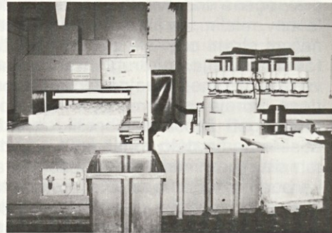
Z moderne centrifuge BERTA in visokofrekvenčnega sušilnika prihaja kvalitetno posušena preja.
