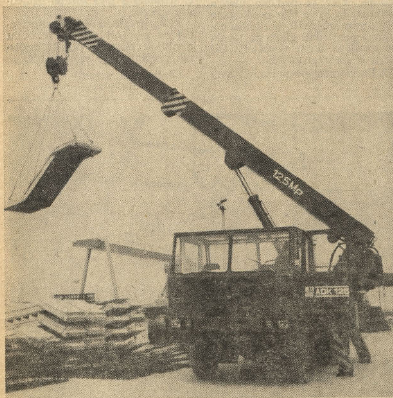
Naš notranji transport se mehanizira. Velik napredek v tej smeri pomeni 12,5 Mp avtodvigalo.
