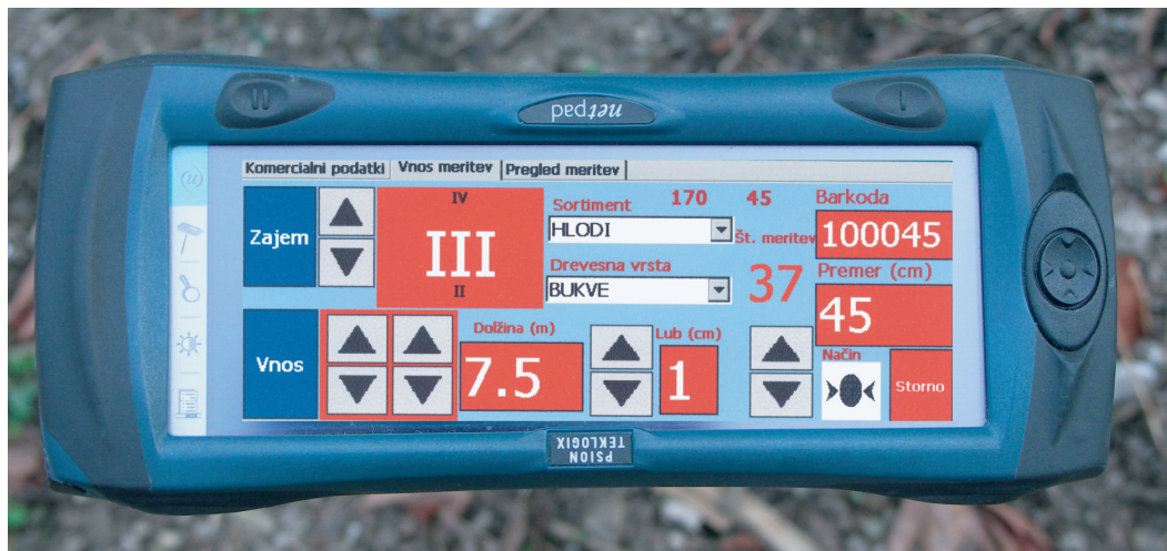
Slika 2. Dlančnik PSION Texlogix netpad in ekranska slika za vnos podatkov o sortimentih
