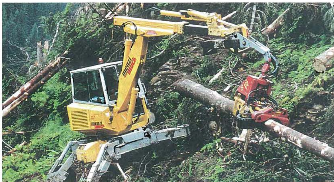
Harvester Menzi Muck s procesorsko glavo WOODY 50 pri delu v ekstremnih terenskih pogojih (foto: proizvajalec)
