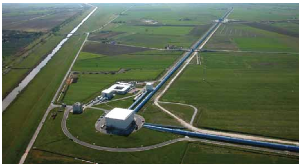
Interferometer VIRGO blizu Pise v Italiji ima kraka, dolga po tri kilometre.
