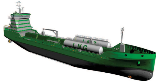
Fig. 2. Hull-independent tank on an LNG carrier [4]
