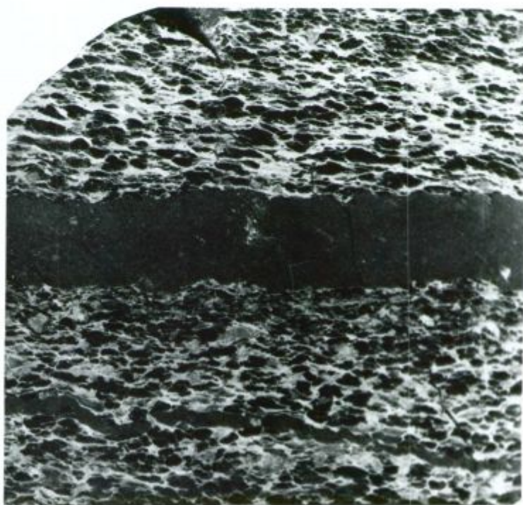
Sl. 3. Debelozrnata kaolinitna usedlina s pšenasto strukturo; v njej dve poli temno-sivega meljevca. Rudno telo Hangend, VII. obzorje, 7. etaža, vzorec 3. Povečava 1,5 \times Abb. 3. Grobkörniger Graupentonstein mit zwei Siltsteinlagen. Erzkörper Hangend, VII. Sohle, 7. Etage, Probe 3. Vergrößerung 1,5 \times
