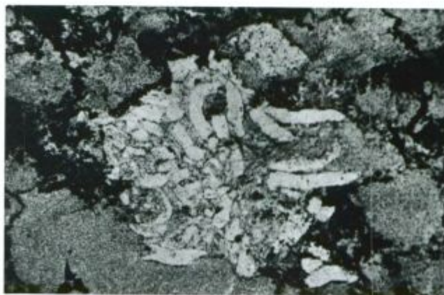
Sl. 6. Kaolinitna zrna s črvičastimi preseki v kriptokristalnem kaolinitu. Rudno telo Hangend, VII. obzorje, 4. etaža, vzorec 4. Presevna polarizirana svetloba, povečava 30 ×
