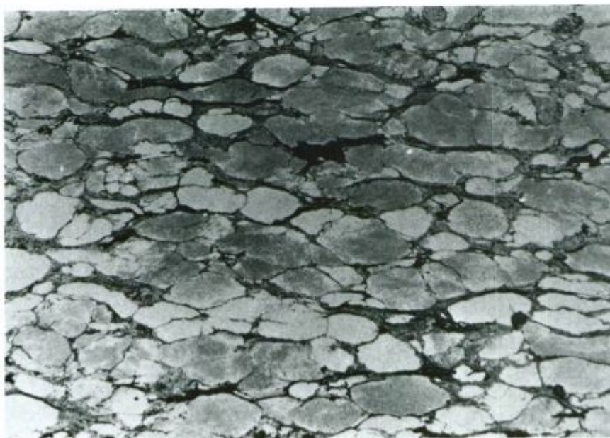
Sl. 4. Debelozrnato kaolinitno usedlino grade predvsem zrna s pšenastim in eliptičnim presekom; veziva je le malo. Črno je pirit. Presevna polarizirana svetloba, povečava 5×. Rudno telo Hangend, VII. horizont, 7. etaža, vzorec 3
