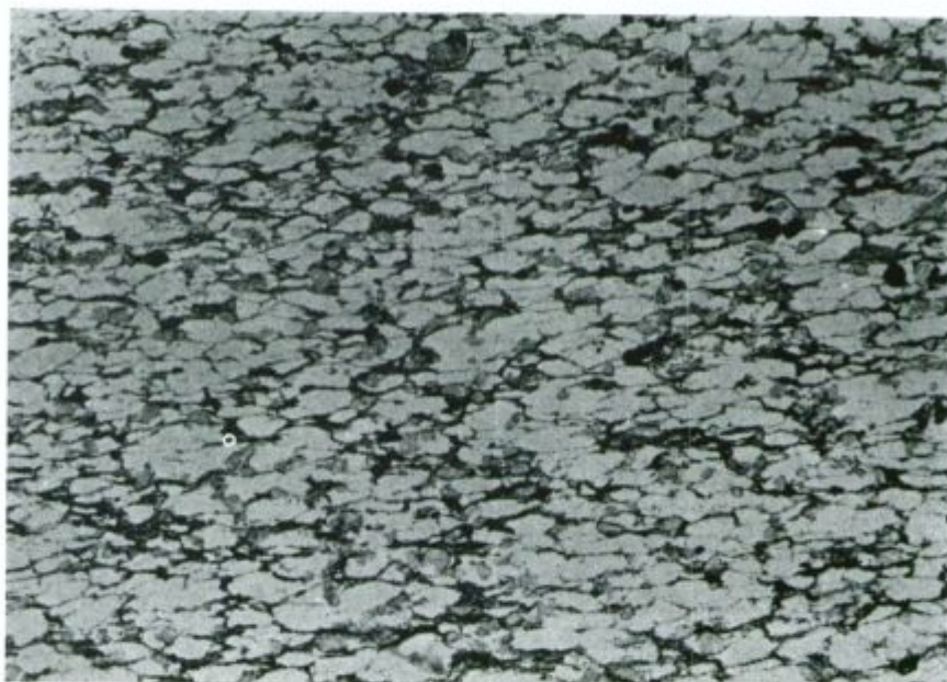
Sl. 5. Srednjezrnata kaolinitna usedlina s pšenasto strukturo. Vezivo je sivo, piritna zrna pa so črna. Pri slepem jašku št. 16, II. obzorje, vzorec 5. Presevna polarizirana svetloba, povečava 7 ×
