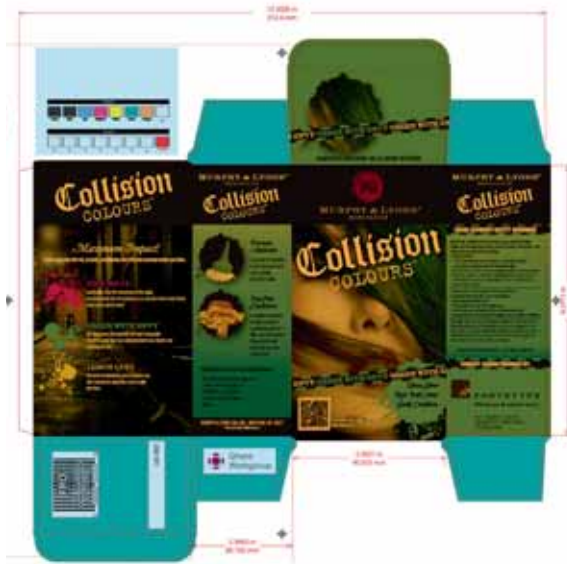
Celotno definirana grafična predloga za izdelavo embalaže, prikazana je kombinacija grafičnih objektov za tisk in dodelavne procese.
