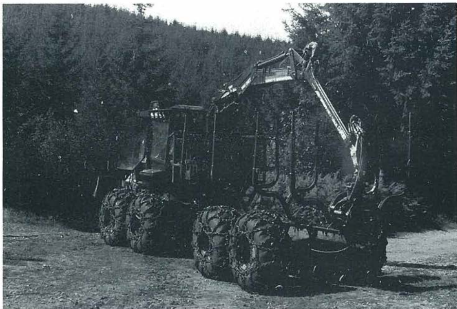
Slika 3: S takšnim traktorjem vozijo iz mlajših sestojev na kratko skrojen les. Tudi posek in razrez sta povsem mehanizirana. Človeška roka se lesa sploh ne dotakne (človeška duša pa tega gozda ne!). (Vse slike – foto: Marko Udovič)
