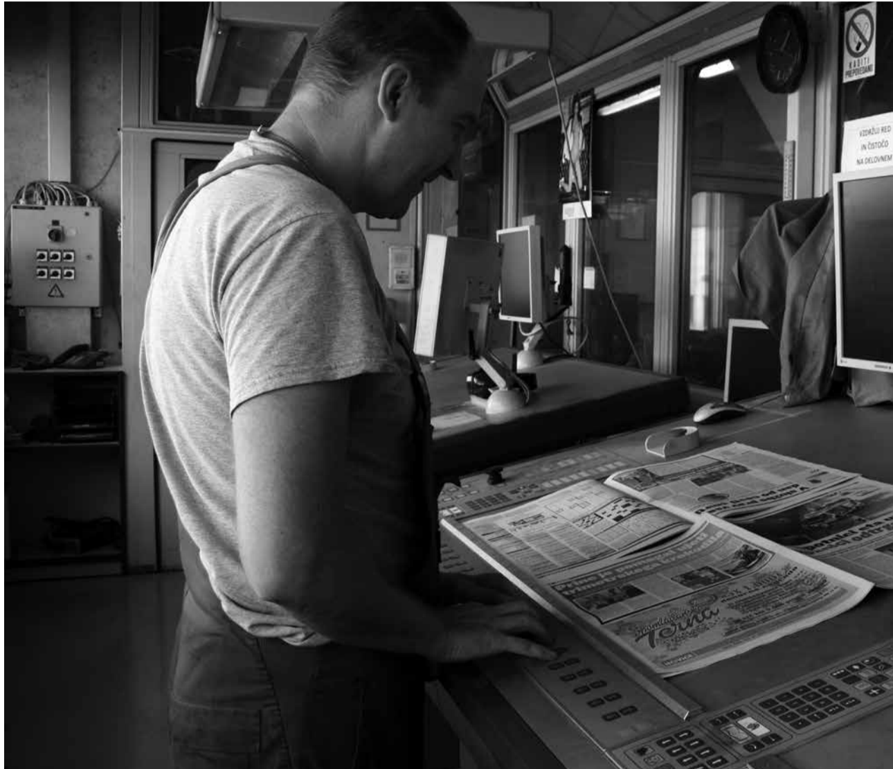
Delavec z napravo odmeri razmerja in intenzivnost barv časopisa, da ne odstopajo preveč od želene stopnje.
