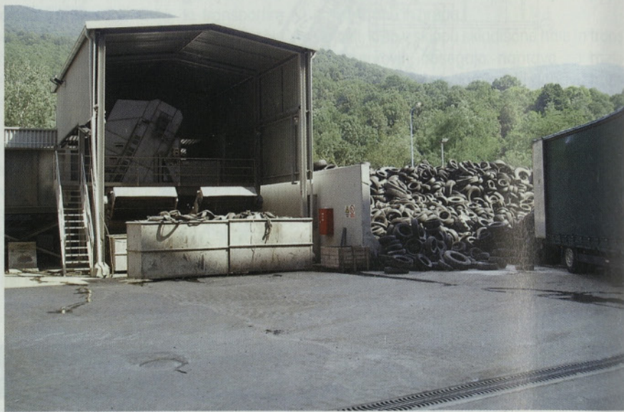
Slika 3 • Zalogovnik, kljukasti transporter in čiščenje pnevmatik
