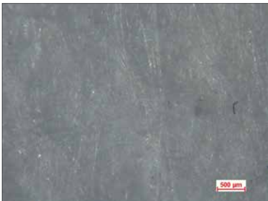
Slika 3. Mikroskopska slika 25-kratne povečave membrane A pred testom
