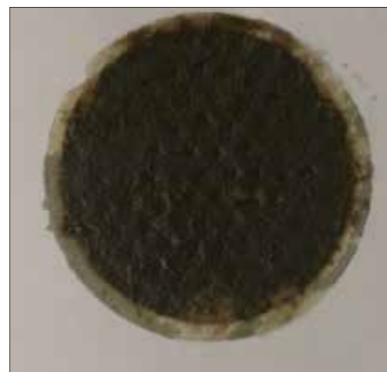
Slika 7. Testirana membrana A po zaključeni filtraciji
