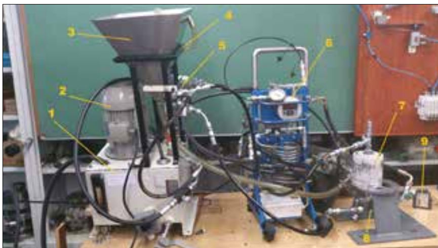
Slika 2. Hidravlično preizkuševališče za testiranje filtrirnih membran po standardu
