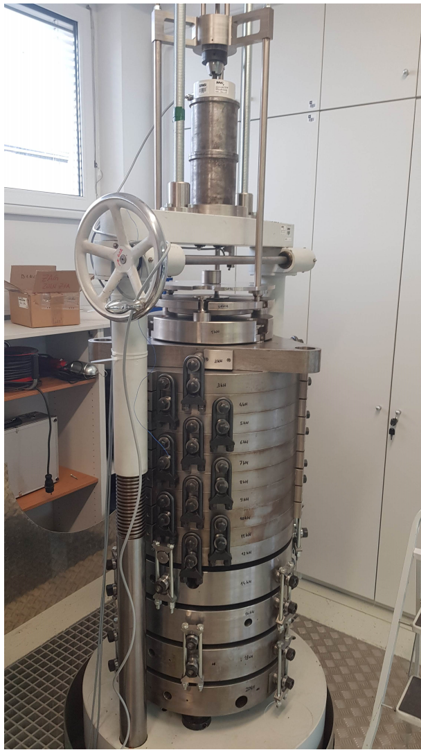
Figure 1: Stroj z neposrednim obremenjevanjem na uteži za sile do 20 kN.
