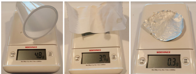
Slika 2: Tehtanje različnih delov PET-plastenke s plastičnim pokrovčkom PEHD in plastificiranim napisom
