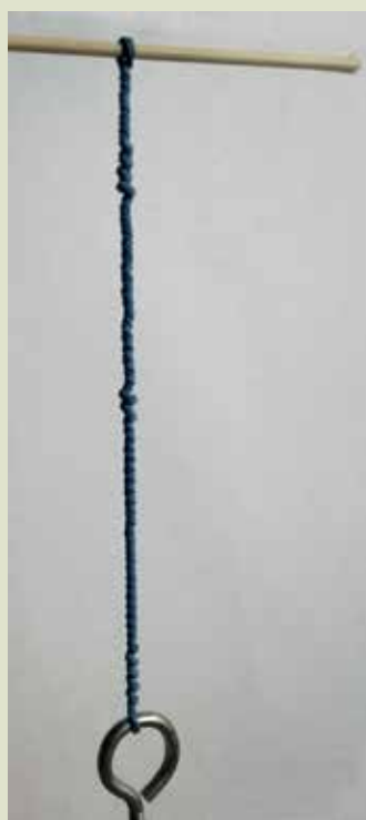
Slika 7: Motor na navito elastiko.
