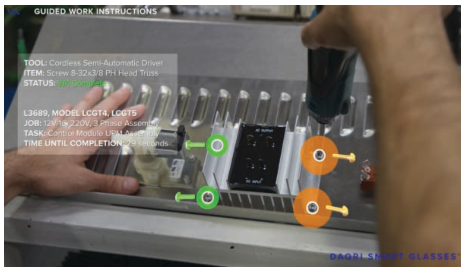
Slika 8: Sestavljanje računalnika s pomočjo očal za AR (Vir 8)
