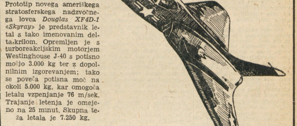
Prototip novega ameriškega stratosferskega nadzvočne lovca Douglas XF4D-1 «Skycray» je predstavnik letal s tako imenovanim delta-krilom. Opremljen je s turboreakcijskim motorjem Westinghouse J-40 s potisno močjo 3.000 kg ter z dopolnilnim izgorovanjem; tako se poveča potisna moč na okoli 5.000 kg, kar omogoča letalu vzpenjanje 76 m/sek. Trajanje letenja je omejeno na 25 minut. Skupna teža letala je 7.250 kg.
