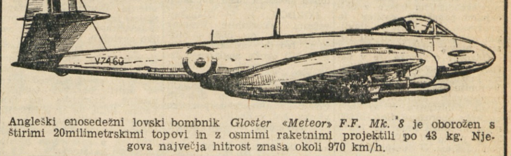
Angleški enosedezni lovski bombnik Gloster «Meteor» F.F. Mk. 8 je oborožen s štirimi 20milimetrskimi topovi in z osmimi raketnimi projektili po 43 kg. Njegova največja hitrost znaša okoli 970 km/h.
