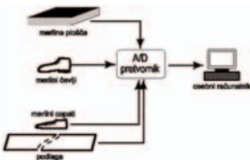
Slika 3. Shematski prikaz naprave za merjenje osnovnih kinematičnih in kinetičnih količin hoje.
