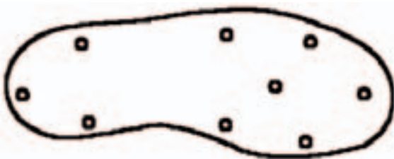
Slika 5. Razporeditev odjemnikov navpičnih sil na podplatu merilnega čevlja.
