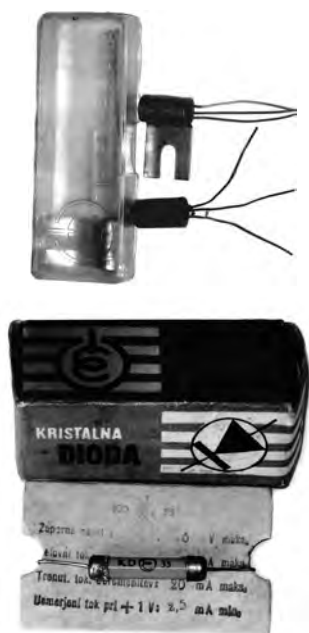
67., 68. Kristalna dioda - Germanijev tranzistor.
