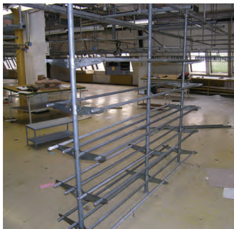
147. Prvi "prototip" knjižnega regala, izdelanega iz kovinskih elementov tračnega sistema.
