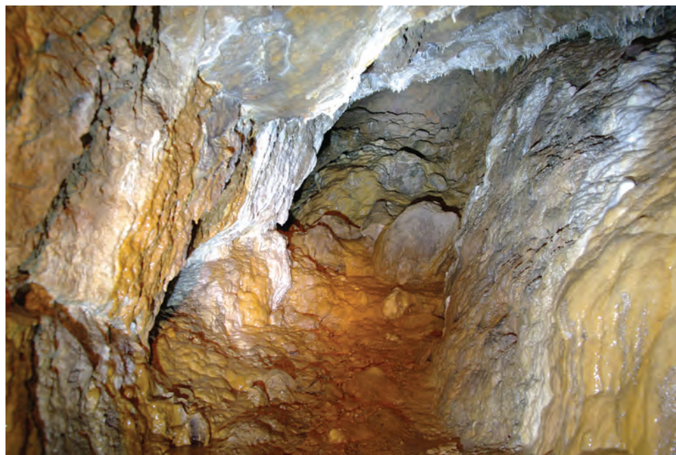
107. Zarušeno in zasigano čelo rudnika železove rude Celarje (foto: Goran Schmidt, leto 2011).
