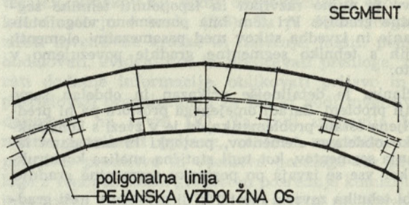
slika 4 ORJENTACIJA SEGMENTOV PRI ZAKRIVLJENEM OBJEKTU
